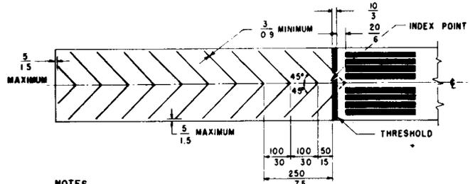
**(b) MARKINGS FOR BLAST PADS AND STOPWAYS**
